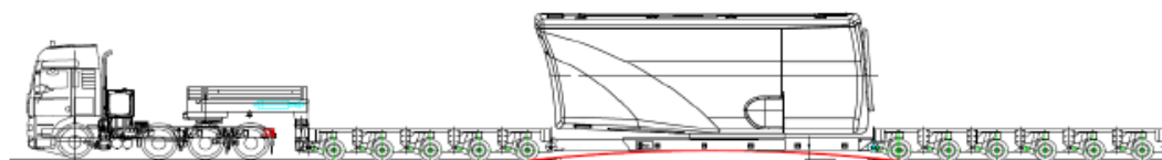
Figure 8 Schema tipo per il trasporto della navicella
